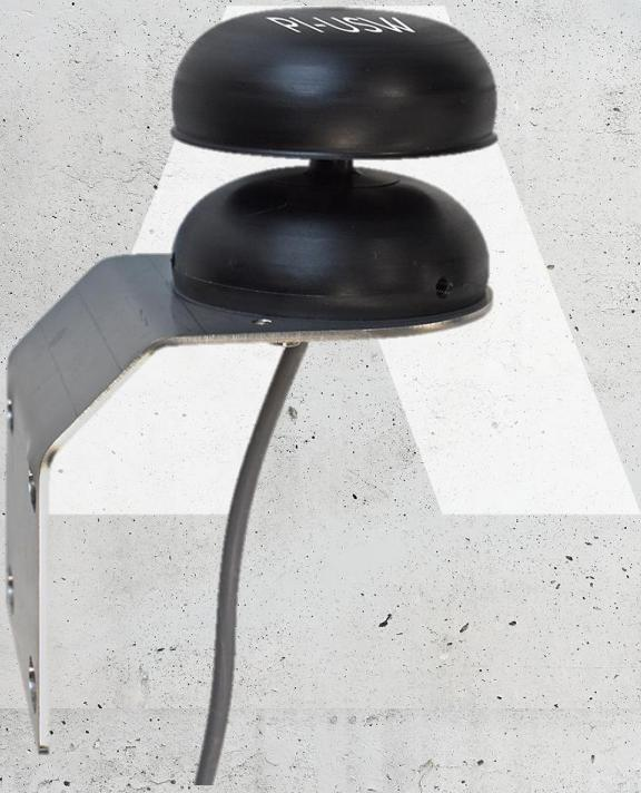
Der Ultraschall-Windgeschwindigkeitssensor von Pessl Instruments ist ein zweidimensionaler Schall-Windsensor, der speziell für Anwendungen in der Land- und Forstwirtschaft sowie in der Umweltforschung entwickelt wurde. Er berechnet die durchschnittliche und maximale (Böen-) Windgeschwindigkeit und -richtung über ein Intervall von 5 Minuten
