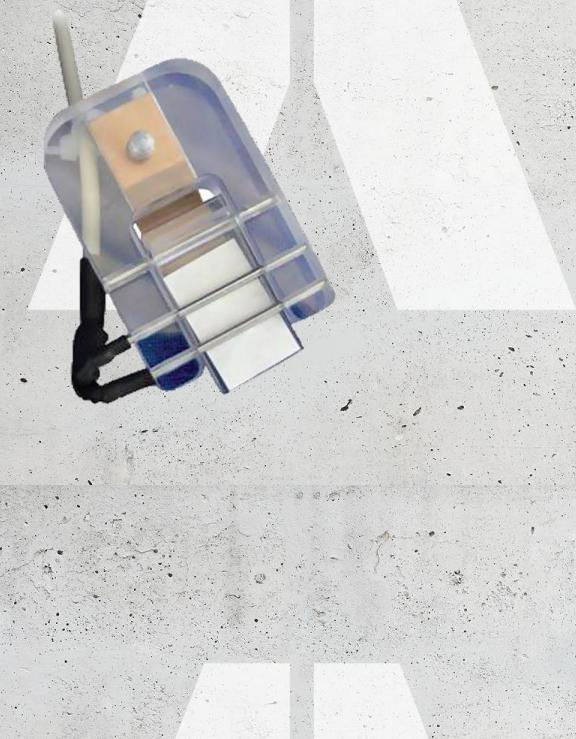
Der Blattnässesensor misst die Leitfähigkeit in einem Filterpapier. Das Filterpapier wird zwischen zwei Edelstahlelektroden in einer transparenten Halterung gehalten. Die Verwendung von transparentem Lucite-Kunststoff als Halterung reduziert das Aufwärmen des Sensors, wenn er direktem Sonnenlicht ausgesetzt ist.
